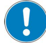
ვალდებულების გამოხატავი ზოგადი აბრა (სადაც საჭიროა, მას სხვა ნიშანი უნდა ახლდეს თან)
